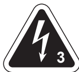
Figure 3. Niveau 3 / Zone 3 : Les câbles à haute tension sont de couleur ORANGE avec des rayures BLANCHES et sont signalés par des drapeaux de sécurité NOIR et BLANC.
